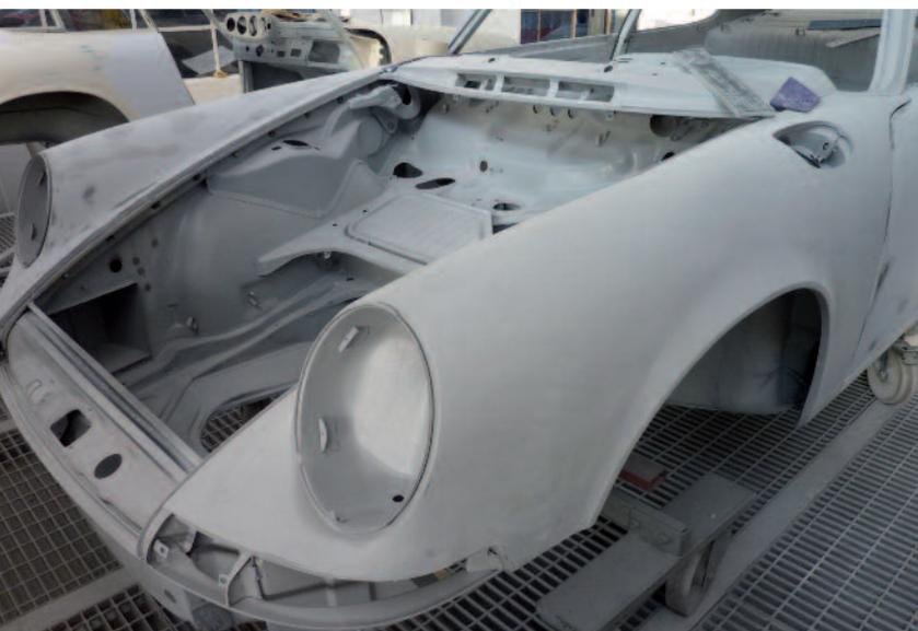
*Isolamento e stuccatura lamiera: prima di procedere alla verniciatura occorre provvedere all'isolamento e protezione delle lamiere con appositi prodotti antiruggine, prima della stuccatura.*
