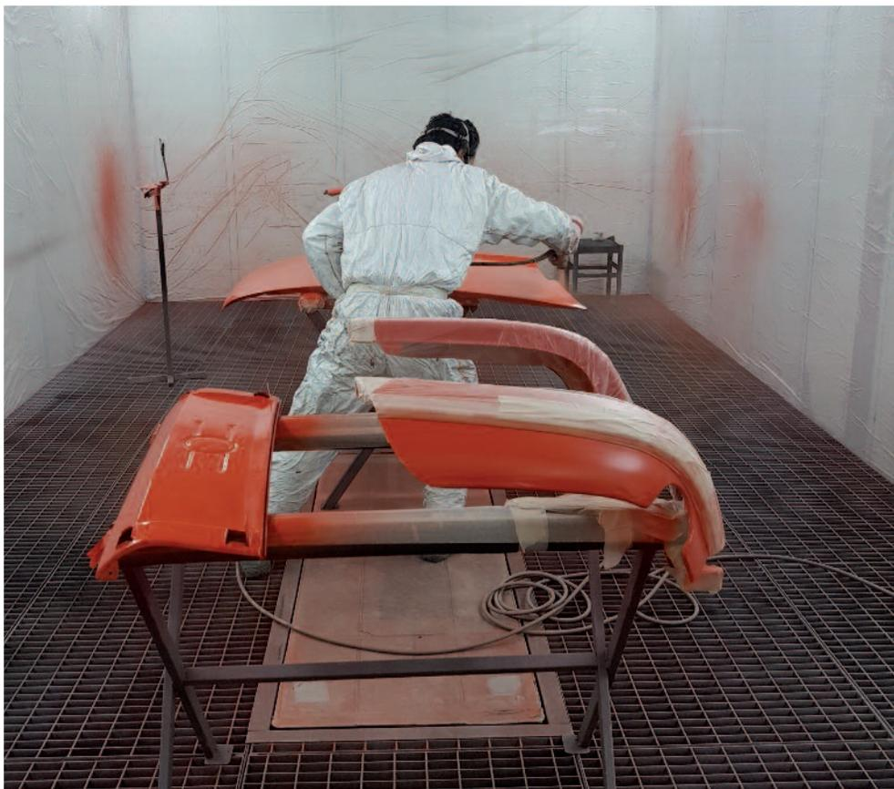
*Cofani, paraurti, porte e particolari vengono anch'essi verniciati a forno ma separatamente per ottenere il miglior risultato*
