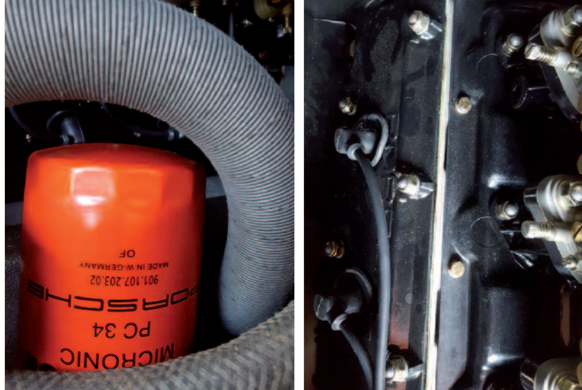
In questa pagina, particolari del motore: da sinistra, il filtro dell'olio, una parte del coperchio delle punterie della bancata di sinistra e i carburatori Weber 40 IDTP con la bobina
